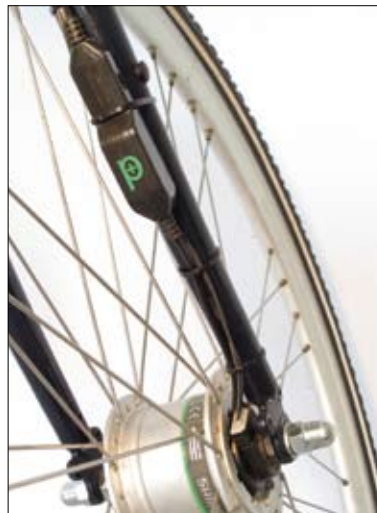
Pedalpower+ universele laadkabel gemonteerd aan de voorvork. De tweede stroomdraad is van de koplamp.
